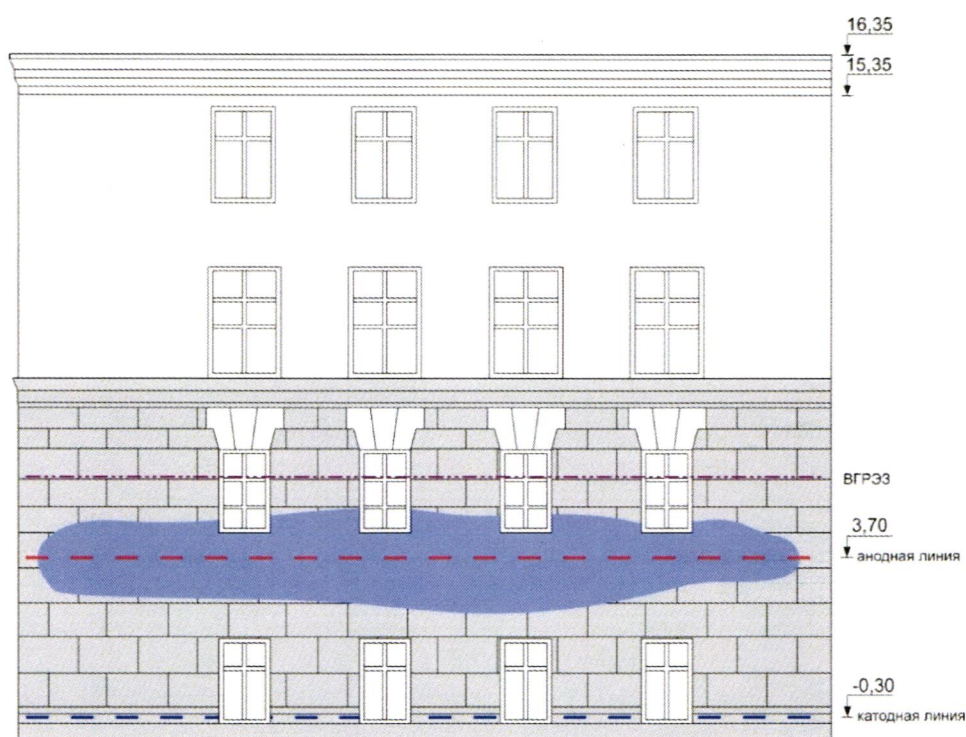
Рисунок 5 – Третий этап осушения стеновых конструкций
