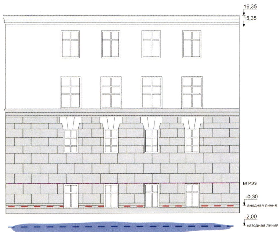
Рисунок 6 – Четвёртый (заключительный) этап осушения стеновых конструкций
